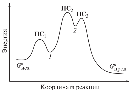
Рис. 1.9. Энергетическая диаграмма реакции гидробromирования этилена: 1 — \pi -комплекс, 2 — ионная пара
